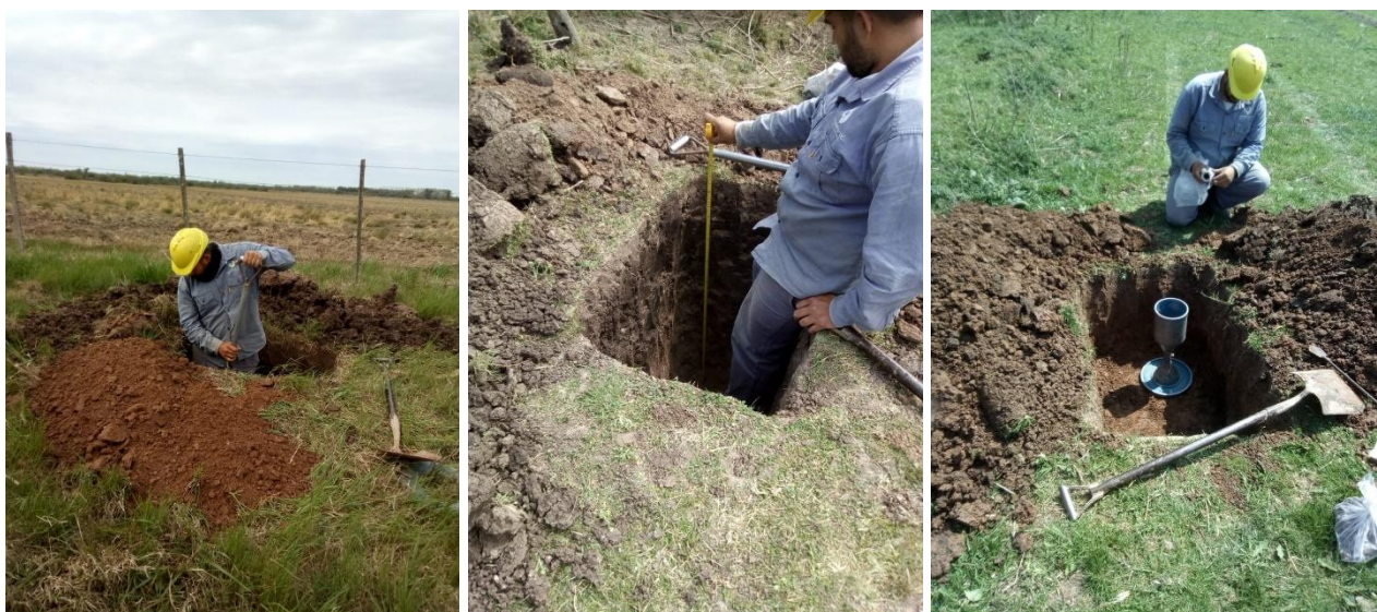
Figura 6.2: Ejecución de calicatas y determinación de densidades
