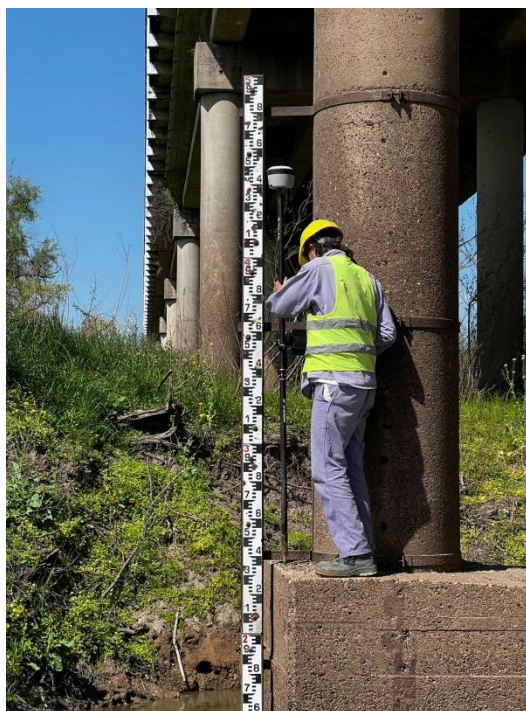
Figura 5.3: Medición de la escala hidrométrica del arroyo Nogoyá
