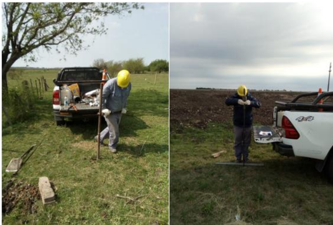
Figura 6.3: Ejecución de sondeo con barreno y ensayo DCP
